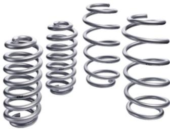
Estos muelles de la marca Eibach se compone de 4 muelles. Sube la suspensión +25mm aprox. Solo apto para tracción 4x2.
