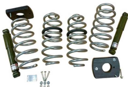
Éste Kit de suspensión, se compone de 4 muelles marca EIBACH, 2 suplementos delanteros y 2 amortiguadores traseros marca KONI. Con éste kit ganamos una altura de +40mm aprox.
