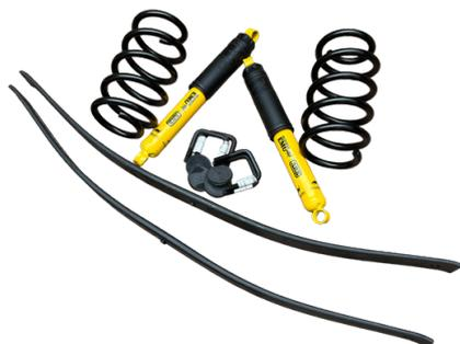
Este Kit de la marca KitBCN se compone de 2 muelles delanteros reforzados y más altos y 2 ballestas traseras reforzadas, también se compone de 2 amortiguadores traseros de la marca OLD MAN EMU. Mejora la estabilidad y aumentan la altura de la suspensión en la parte delantera entre +50/60mm y en la parte trasera entre +70/80mm aprox.
